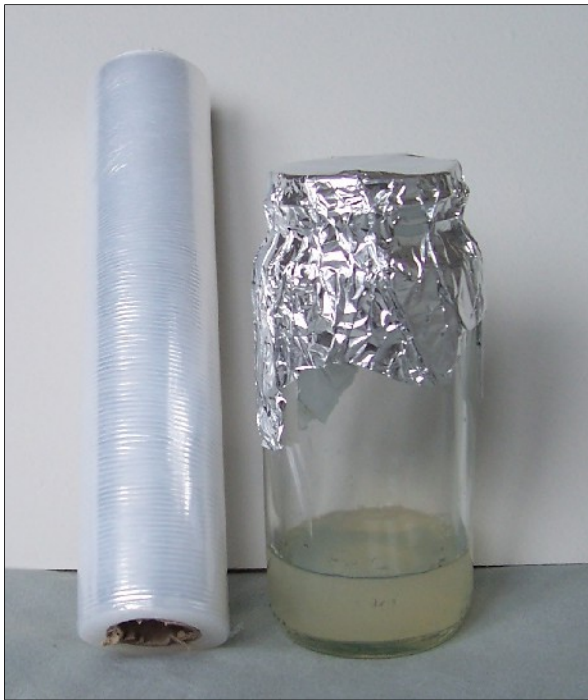
Plastfolie til at blive steriliseret i mikroovnen og medium til trykkogeren.
